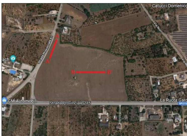
Fig. 12 Ubicazione degli stendimenti sismici su foto aerea
