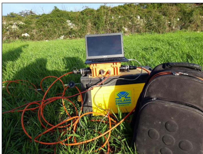
Fig. 1 Sismografo DOLANG a 24 canali modello DBS280
