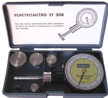
FIGURA 14 - PENETROMETRO TASCABILE, MODELLO ST 308 (FONTE IN SITOGRAFIA).
